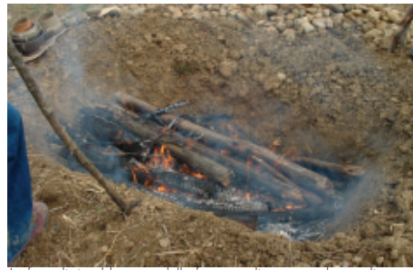
La fase di riscaldamento della fossa, realizzata con legna di grande pezzatura.
